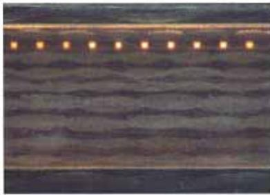
図2 光配線基板の断面写真。導波路は50×50 $\mu\text{m}$ 。10層FR4基板の4層目に形成。
