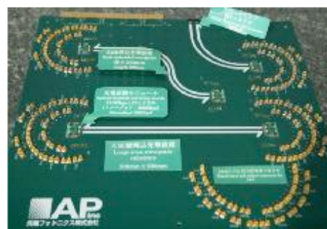
約200mm角基板内に12.5Gbpsの光導波路24本を設けた、合計300Gbpsの光伝送可能な実装基板の試作品
